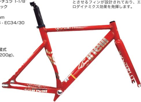
正統派のトラックフレームは、市街地で行われる過酷なレースにも対応し、タイトなコーナーも駆け抜けます。シートステーをショート化し、リア三角を小さくする事で剛性を確保。ホイールアーチに沿ったエアロ形状のシートチューブを採用しています。BB下にはレーザーを彷彿とさせるフィンが設計されており、エアロダイナミクス効果を発揮します。
